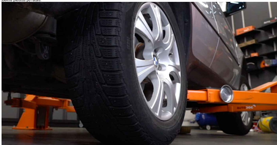
6 Atlaisvinkite rato tvirtinimo varžtus. Naudokite specialią galvutę ratų varžtams Nr. 19
