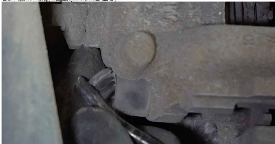
12 Atsukite stabdžių apkabos tvirtinimą. Naudokite HEX Nr. H7. Naudokite terkšlini rakta.
