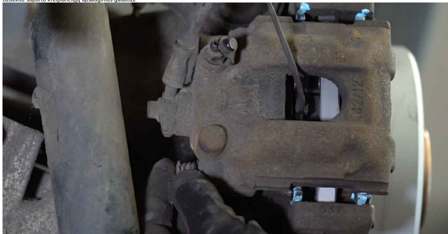
24 Sumontuokite stabdžių suportu fiksavimo spyruokle.
