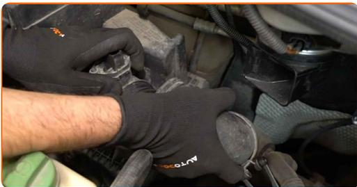
**6** Uždenkite oro įsiurbimo žarną mikropluošto rankšluosčiu, tam, kad išvengtumėte purvo ir dulkių patekimo į sistemą.
