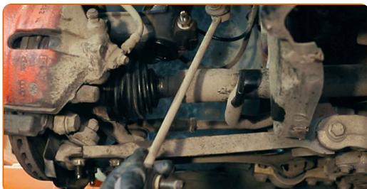
Keitimas: stabilizatoriaus traukės – VW TOURAN (1T3). Patarimas iš AUTODOC ekspertų:
