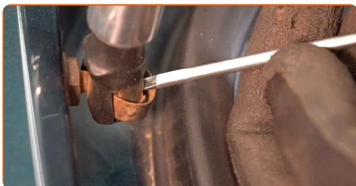
**Keitimas: bagažinės amortizatorių – VW PASSAT Variant (3B5). Patarimas:**
