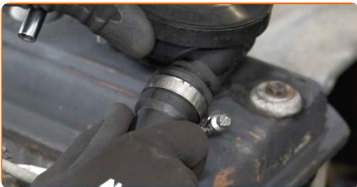
43 Uždenkite karterio ventiliavimo sistemos vamzdžio angą servetėle iš mikropluošto, kad išvengtumėte purvo ir pašalinių objektų pateikimo į vidų.
