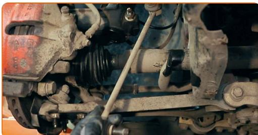
Keitimas: stabilizatoriaus traukės – VW Passat Alltrack (365). Patarimas iš AUTODOC ekspertų:
