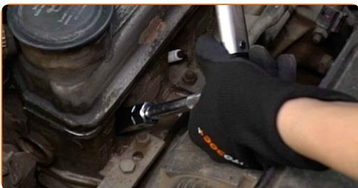
Keitimas: uždegimo žvakių – VW New Beetle Hatchback (9C1, 1C1).
