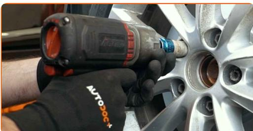
21 Nuleiskite automobilį ir, kryžmine tvarka, priveržkite ratų tvirtinimo varžtus. Naudokite specialią galvutę ratų varžtams Nr. 17 Naudokite dinamometrinį raktą. Priveržimo jėga 120 Nm.
