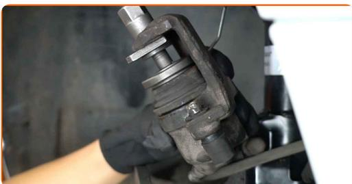
**18** Sumontuokite stabdžių suportą ir pritvirtinkite jį. Naudokite HEX Nr. H7. Naudokite dinamometrinį raktą. Priveržimo jėga 25 Nm.
