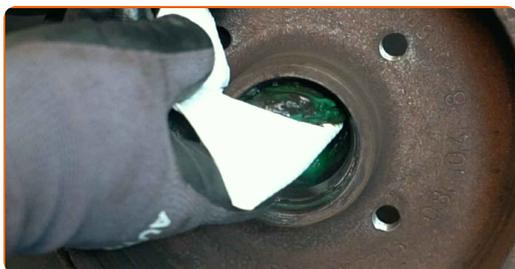
**18** Išimkite vidinę rato guolio apkabą iš stabdžių būgno. Naudokite trikojį nuėmėją. Naudokite rinkinį guolių įpresavimui ir išpresavimui.
