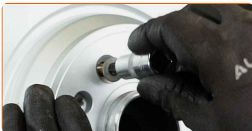
**26** Priveržkite stabdžių disko tvirtinimus. Naudokite Torx T50. Naudokite dinamometrinių raktą. Priveržimo jėga 15 Nm.
