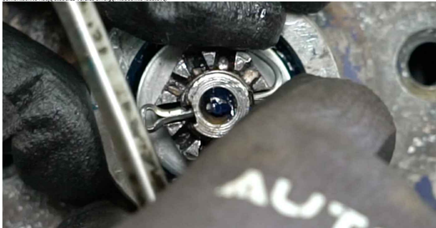
34 Uždėkite stebulės veržlės dangtelį. Naudokite guminį plaktuką.
