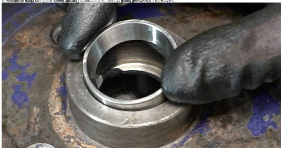
19 Sumontuokite vidinę rato guolio apkabą į stabdžių būgną. Rinkinys guolių įpresavimui ir išpresavimui.
