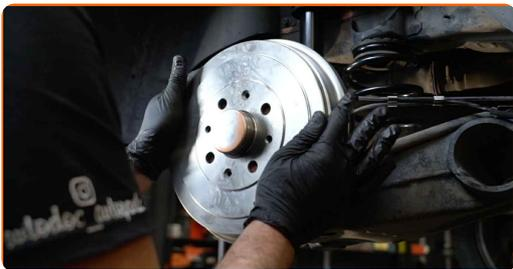
**20** Priveržkite stabdžių būgno tvirtinimus. Naudokite Torx T 30. Naudokite dinamometrinį raktą. Priveržimo jėga 4 Nm.
