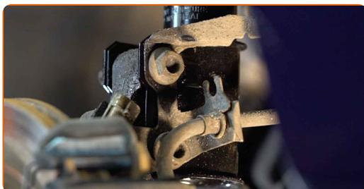
**37** Pritvirtinkite stabilizatoriaus traukę prie amortizatoriaus statramsčio. Naudokite kombinuotą veržliaraktį Nr. 19. Naudokite torcinę galvutę Nr. 18. Naudokite dinamometrinių raktą. Priveržimo jėga 65 Nm.
