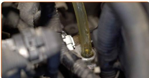
Keitimas: mechaninės pavarų dėžės tepalas – VAUXHALL COMBO Mk II (C) dėžės kėbulas / universalas (F25). Patarimas iš AUTODOC ekspertų:
