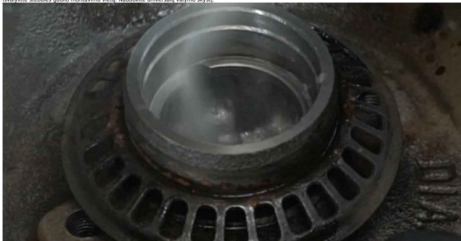
18 Sumontuokite naują rato guolio išorinę apkabą į stabdžių būgną. Rinkinys guolių įpresavimui ir išpresavimui.
