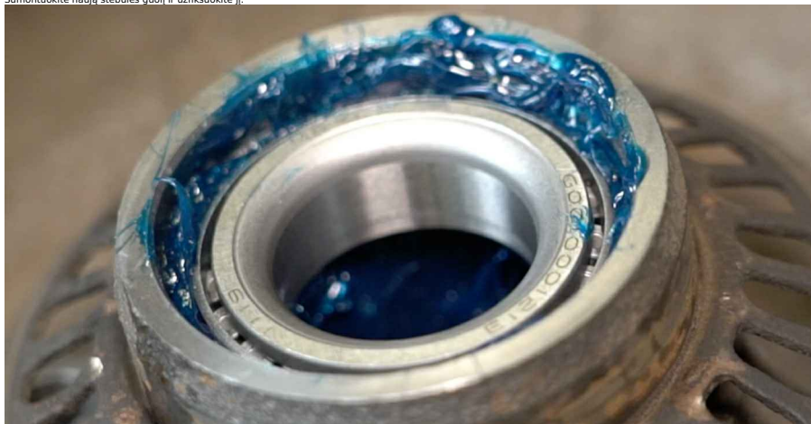
22 Sumontuokite stebulės guolio riebokšlį.
