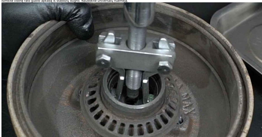
15 Išimkite vidinę rato guolio apkabą iš stabdžių būgno. Naudokite universalią nuėmėją.
