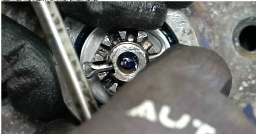
34 Uždėkite stebulės veržlės dangtelį. Naudokite guminį plaktuką.
