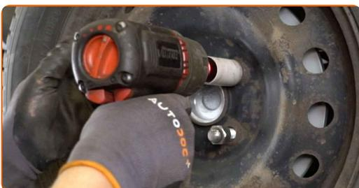
**26** Nuleiskite automobilį ir, kryžmine tvarka, priveržkite ratų tvirtinimo varžtus. Naudokite specialią galvutę ratų varžtams Nr. 21 Naudokite dinamometrinių raktą. Priveržimo jėga 103 Nm.
