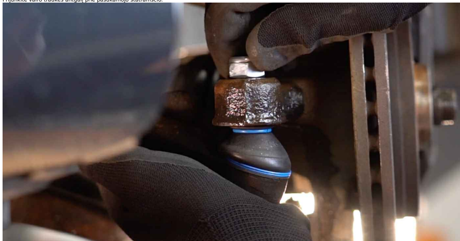
18 Priveržkite tvirtinimo veržlę, jungiančią vairo traukės antgalį prie pasukamojo kakliuko. Naudokite torcinę galvutę Nr. 17. Naudokite dinamiškinį raktą. Priveržimo jėga 33 Nm.
