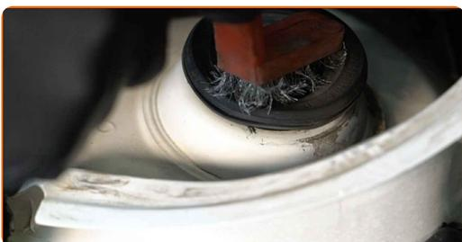
**7** Atveržkite viršutinius amortizatoriaus statramsčio atramos tvirtinimus. Naudokite kombinuotą veržliaraktį Nr. 21. Naudokite HEX Nr. H6. Naudokite terkšlinį raktą.
