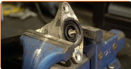
**22** Priveržkite amortizatoriaus koto tvirtinimus. Naudokite antgalį-galvutę amortizatoriui DDN<sup>®</sup>6. Naudokite torcinę galvutę Nr. 18. Naudokite dinamometrinį raktą. Priveržimo jėga 35 Nm.
