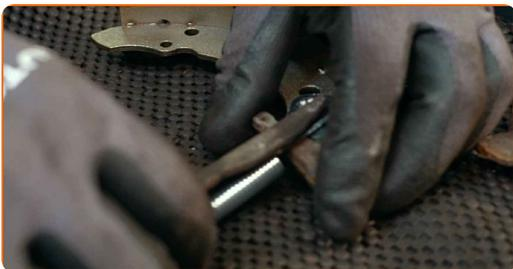
**22** Sumontuokite viršutines fiksavimo spyruokles ir reguliavimo mechanizmą ant naujų stabdžių trinkelį. Naudokite plokščią atsuktuvą.
