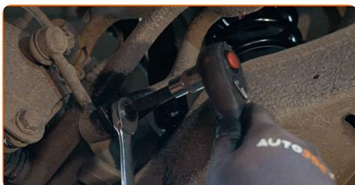
**10** Paremkite svirtį. Naudokite hidraulinį pakelėją.
