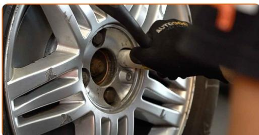
**22** Nuleiskite automobilį ir, kryžmine tvarka, priveržkite ratų tvirtinimo varžtus. Naudokite dinamometrinių raktą. Priveržimo jėga 110 Nm.
