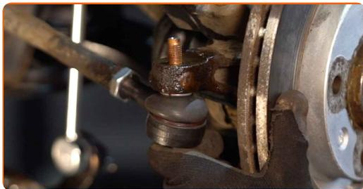
**15** Išmatuokite ir įsiminkite laisvos vairo traukės sriegių dalies ilgį arba įsiminkite pilnų detalės apskimų skaičių demontavimo metu, kad vėliau išvengtumėte ratų suvedimo kampo pažeidimo. Naudokite slankmatį.
