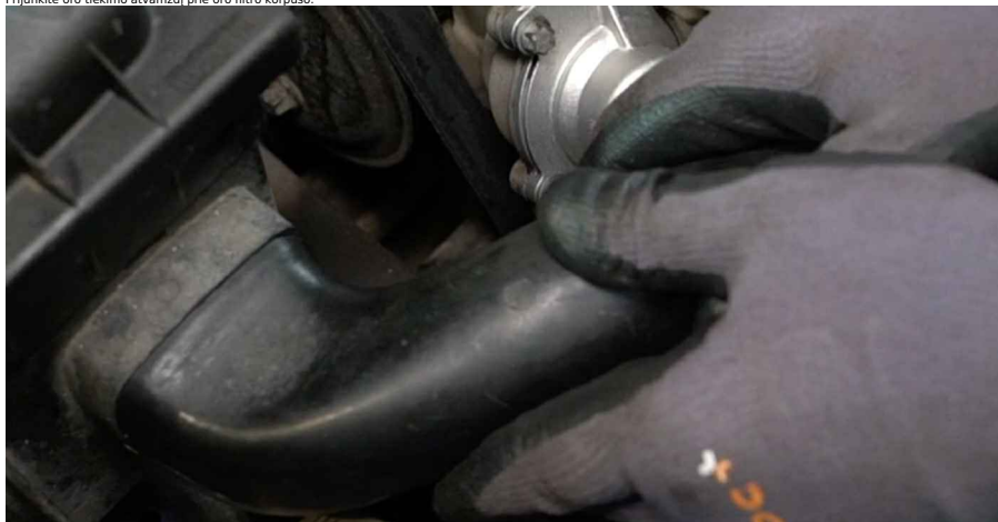
32 Pritvirtinkite fikساتorių ant oro filtro įsiurbimo žarnos.
