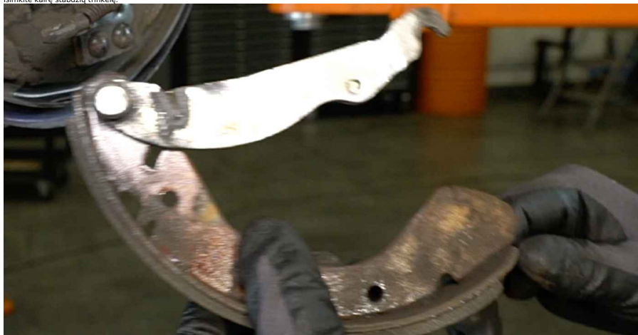
Keltimas: būginių stabdžių kaladėlių - OPEL Corsa C Van (X01). Patarimas iš AUTODOC:
