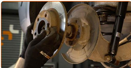
**Keitimas: stabdžių diskų – OPEL Corsa C Hatchback (X01). Patarimas:**
