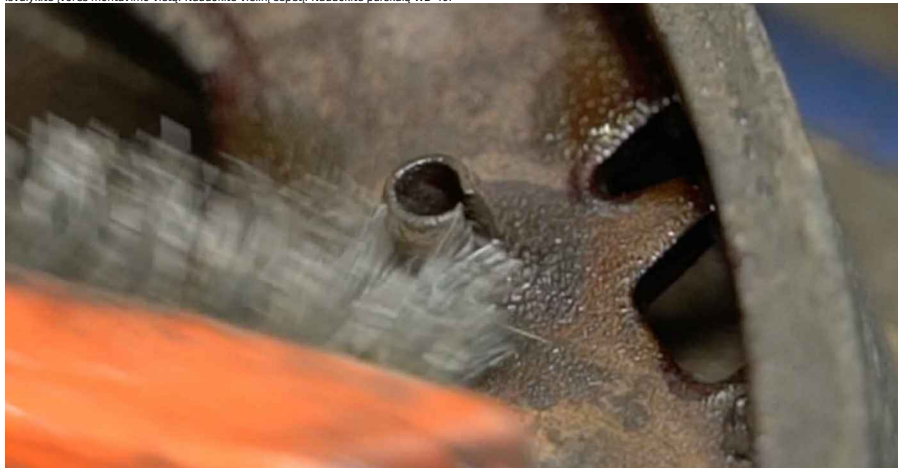
30 Išimkite įvorę. Naudokite santechnines reples.
