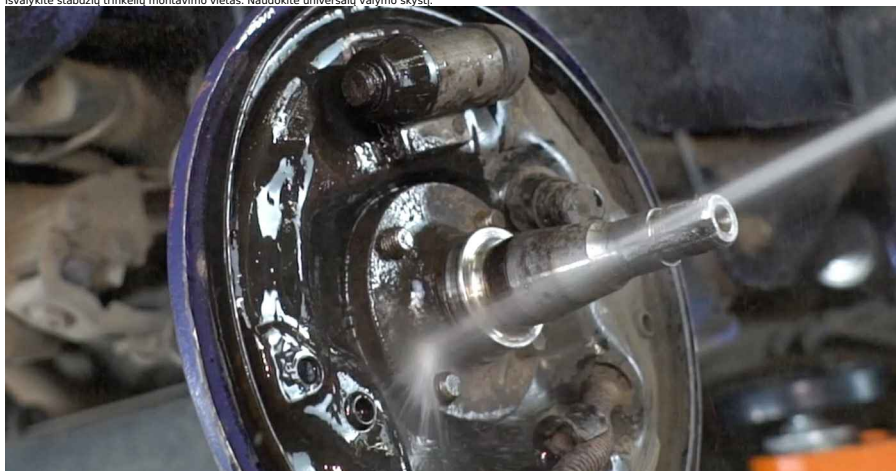
22 Išvalykite stabdžių trinkelė montavimo vietas. Naudokite universalų valymo skystį.
