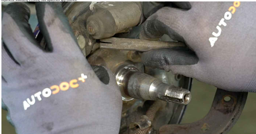
18 Išimkite dešinę stabdžių trinkelę.
