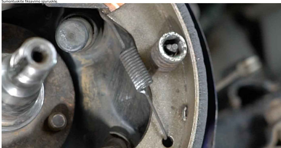
40 Sumontuokite viršutinę spyruoklę. Naudokite prailgintas apvaliąsias reples.
