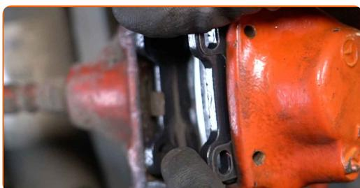
**44** Įdėkite stabdžių trinkelėlių tvirtinimo spyruoklę.
