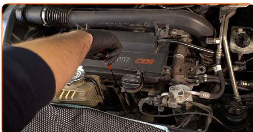
Keitimas: alyvos ir filtru – MERCEDES-BENZ Sprinter 3-T Van (W903).
