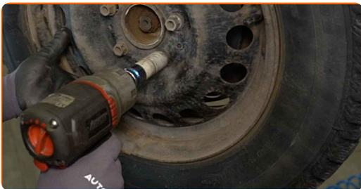
**49** Nuleiskite automobilį ir, kryžmine tvarka, priveržkite ratų tvirtinimo varžtus. Naudokite specialią galvutę ratų varžtams Nr. 17 Naudokite dinamometrinių raktą. Priveržimo jėga 110 Nm.
