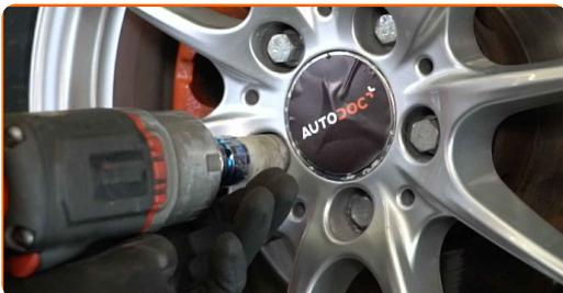
**55** Nuleiskite automobilį ir, kryžmine tvarka, priveržkite ratų tvirtinimo varžtus. Naudokite specialią galvutę ratų varžtams Nr. 17 Naudokite dinamometrinių raktą. Priveržimo jėga 110 Nm.
