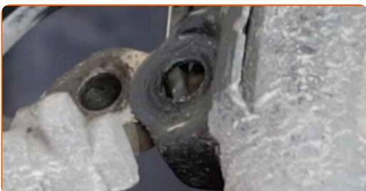
**20** Išvalykite stabilizatoriaus įvorių apkabų tvirtinimus. Naudokite vielinį šepetį. Naudokite purškalą WD-40.
