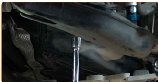
**13** Atsukite porėmio apkabos tvirtinimo elementus. Tai būtina norint pasiekti viršutinį pakabos svirties tvirtinimo varžtą. Naudokite Torx E10. Naudokite Torx E14. Naudokite terkšlinį raktą.
