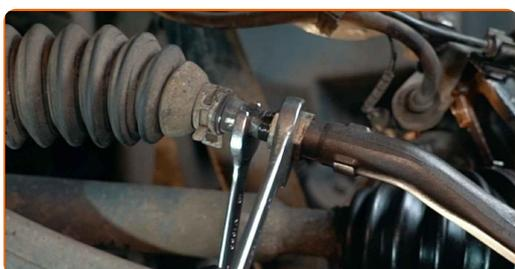
**17** Išmatuokite ir įsiminkite laisvos vairo traukės sriegių dalies ilgį arba įsiminkite pilnų detalės apskimų skaičių demontavimo metu, kad vėliau išvengtumėte ratų suvedimo kampo pažeidimo. Naudokite slankmatį.
