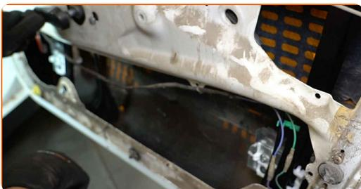
**18** Nuleiskite stiklą ir sumontuokite jį į montavimo vietą stiklo pakelėjo mechanizme.
