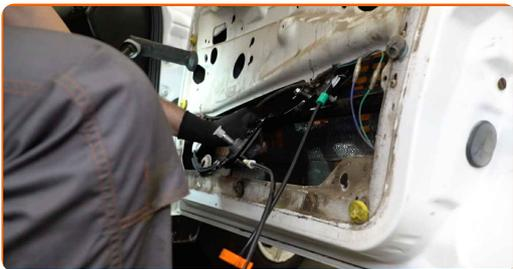
**15** Priveržkite lango reguliavimo mechanizmo tvirtinimus. Naudokite torcinę galvutę Nr. 10. Naudokite dinamometrinių raktą. Priveržimo jėga 10 Nm.
