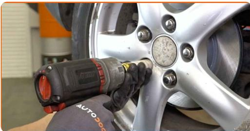
**45** Nuleiskite automobilį ir, kryžmine tvarka, priveržkite ratų tvirtinimo varžtus. Naudokite specialią galvutę ratų varžtams Nr. 19 Naudokite dinamometrinių raktą. Priveržimo jėga 108 Nm.
