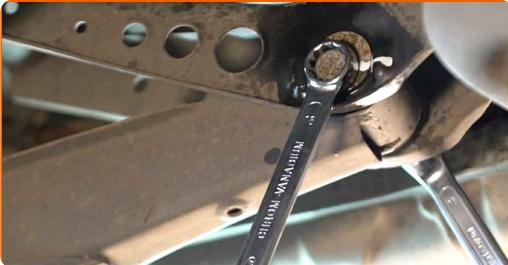
9 Paremkite svirtį. Naudokite hidraulinį pakelėją.
