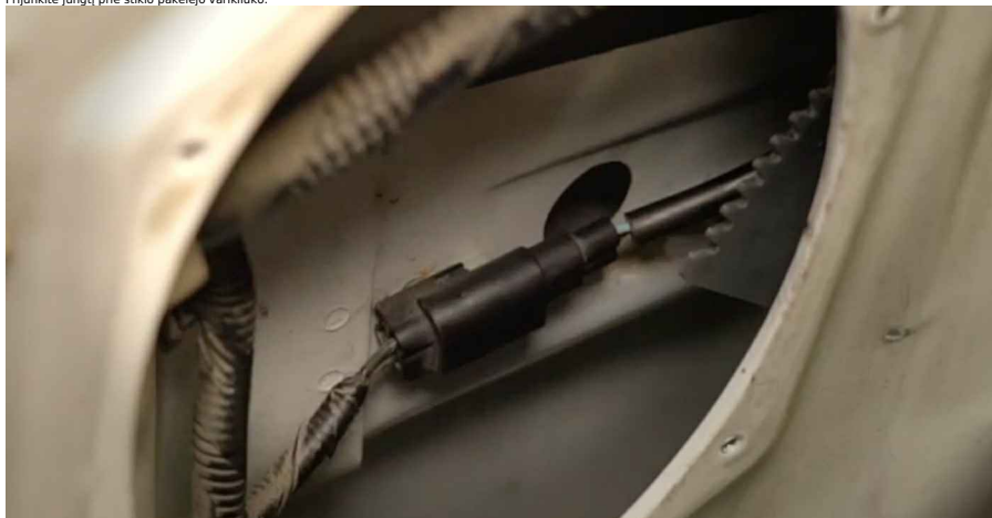
24 Sumontuokite lango kreipiamojo bėgio tvirtinimo varžtą.
