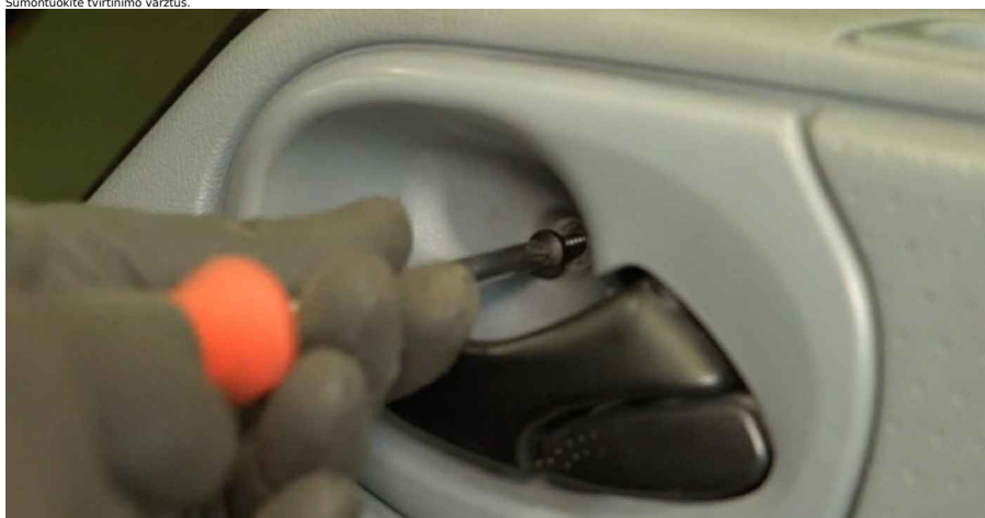
42 Priveržkite durų panelės tvirtinimus. Naudokite kryžminį atsuktuvą.
