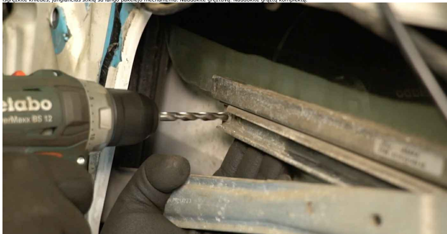
14 Išgręžkite kniedes, jungiančias lango pakėlejo mechanizmą su durimis. Naudokite gręžtuvą. Naudokite grąžtų komplektą.
