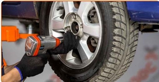
**48** Nuleiskite automobilį ir, kryžmine tvarka, priveržkite ratų tvirtinimo varžtus. Naudokite specialią galvutę ratų varžtams Nr. 19 Naudokite dinamometrinį raktą. Priveržimo jėga 95 Nm.
