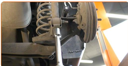
**10** Atsukite viršutinį amortizatoriaus tvirtinimą. Naudokite torcinę galvutę Nr. 10. Naudokite terkšlinį raktą.
