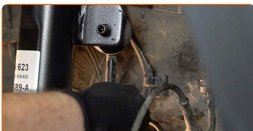
**38** Priveržkite stabilizatoriaus traukės tvirtinimą prie amortizatoriaus statrumsčio. Naudokite kombinuotą veržliaraktį Nr. 17. Naudokite dinamometrinį raktą. Priveržimo jėga 55 Nm.
