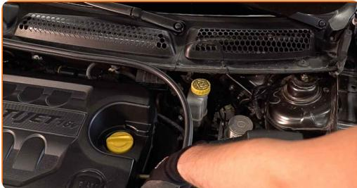
5 Atveržkite viršutinius amortizatoriaus statramsčio atramos tvirtinimus. Naudokite kombinuotą veržliaraktį Nr. 19.
