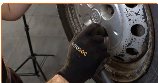
**22** Nuleiskite automobilį ir, kryžmine tvarka, priveržkite ratų tvirtinimo varžtus. Naudokite dinamometrinį raktą. Priveržimo jėga 98 Nm.
