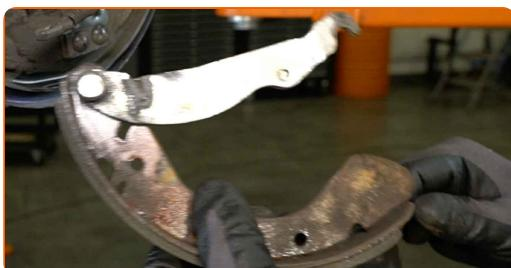
Keitimas: būgninių stabdžių kaladėlių – Opel Corsa S93. Patarimas iš AUTODOC:
