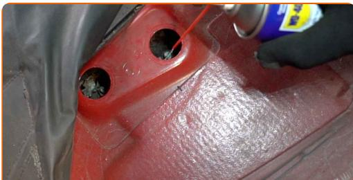
**4** Atlaisvinkite viršutinių amortizatoriaus tvirtinimą. Naudokite torcinę galvutę Nr. 13. Naudokite terkšlinį raktą.
