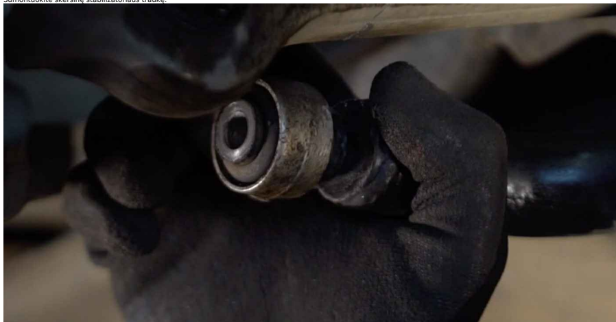
67 Priveržkite stabilizatoriaus traukę tvirtinimą.
