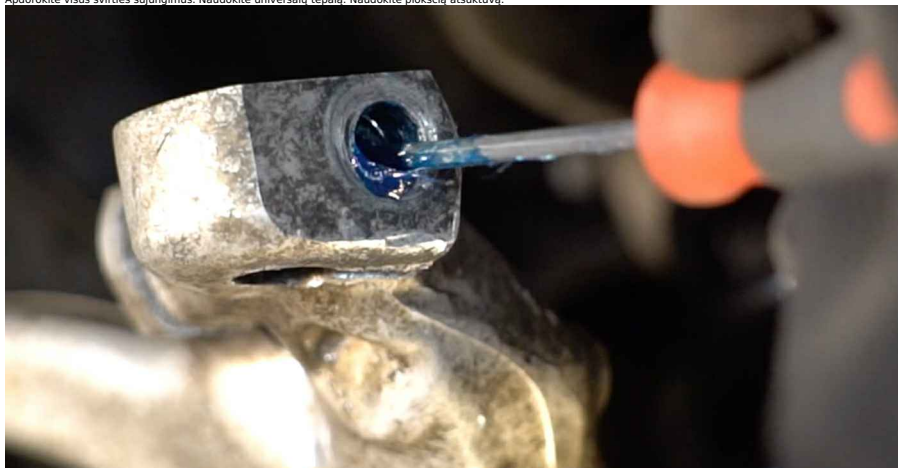
63 Prisukite viršutinę pakabos svirtį nuo pasukamojo kakliuko (2 vnt.).
