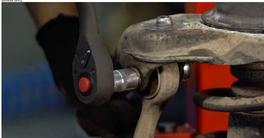
34 Atsukite pakabos svirčių tvirtinimą prie statramsčio atramos. Naudokite kombinuotą veržliaraktį Nr. 16. Naudokite torcinę galvutę Nr. 16. Naudokite terkšlinį rakta.
