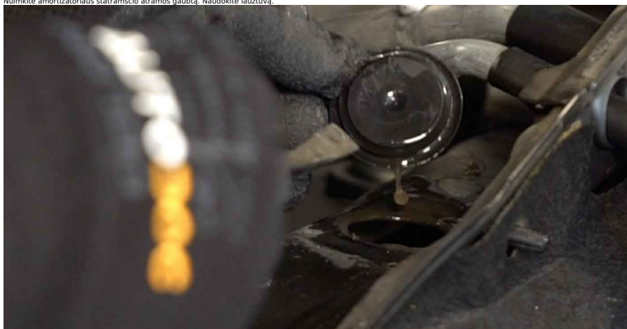
6 Atveržkite viršutinius amortizatoriaus statramsčio atramos tvirtinimus. Naudokite torcinę galvutę Nr. 16. Naudokite terkšlinį raktą.
