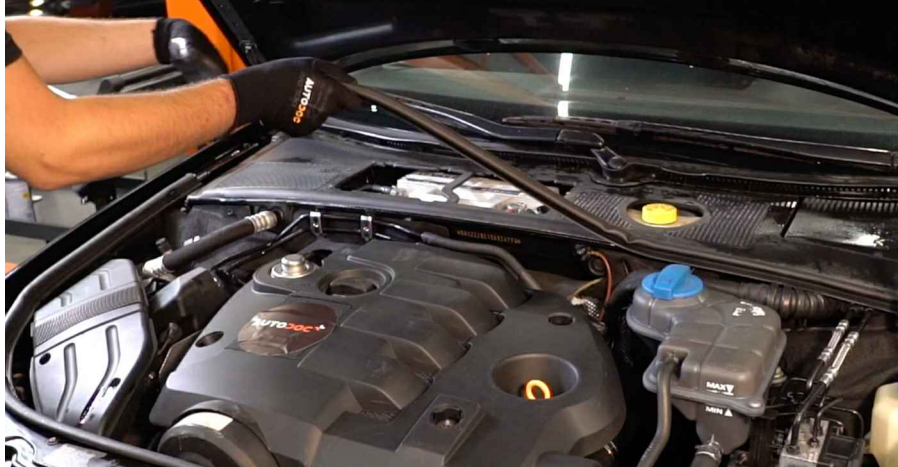
3 Pakelkite ir išimkite valytuvų plastikinę grotelę.
