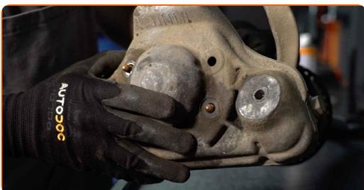
**45** Priveržkite viršutinį amortizatoriaus statramsčio atramos tvirtinimą. Naudokite torcinę galvutę Nr. 13. Naudokite dinamometrinį raktą. Priveržimo jėga 22 Nm.
