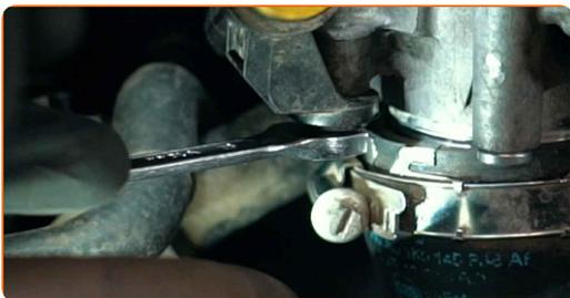
**61** Pritvirtinkite oro tiekimo sistemos tvirtinimą. Naudokite torcinę galvutę Nr. 7. Naudokite terkšlinį raktą.
