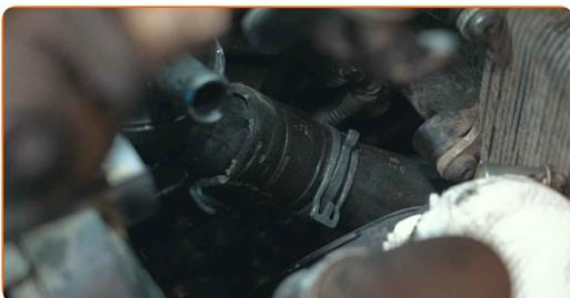
**45** Uždėkite viršutinės aušinimo žarnos apkabą. Naudokite prailgintas reples.
