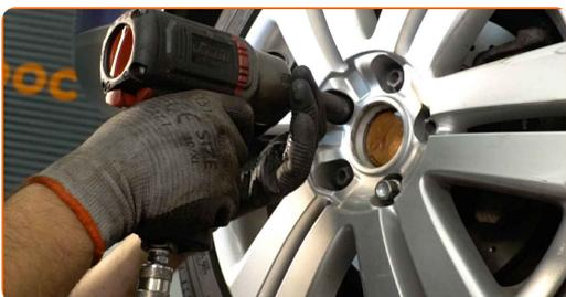
35 Nuleiskite automobilį ir, kryžmine tvarka, priveržkite ratų tvirtinimo varžtus. Naudokite specialią galvutę ratų varžtams Nr. 17 Naudokite dinamometrinį raktą. Priveržimo jėga 120 Nm.
