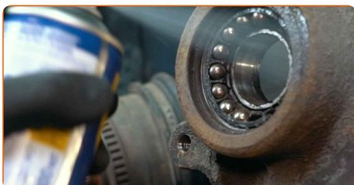
**25** Išspauskite rato stebulės guolį. Naudokite rinkinį guolių įpresavimui ir išpresavimui. Naudokite guolių nuėmėją.
