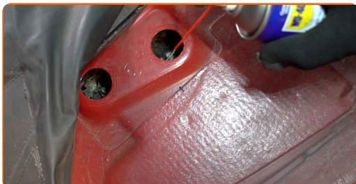
**4** Atlaisvinkite viršutinį amortizatoriaus tvirtinimą. Naudokite torcinę galvutę Nr. 13. Naudokite terkšlinį raktą.
