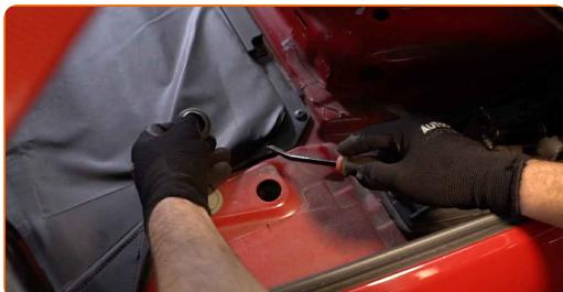
**3** Išvalykite viršutinės amortizatoriaus atramos tvirtinimus. Naudokite purškalą WD-40.
